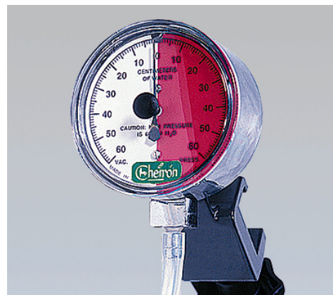
Figur 18. Manometer för tryckvisning vid thoraxdränering
